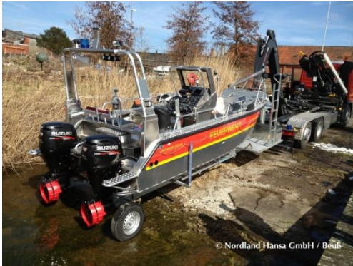
Abb. 14: Absetzen mit Wechsellader
