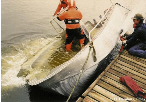
Abb. 12: Kenterversuch mit einem Neubau
